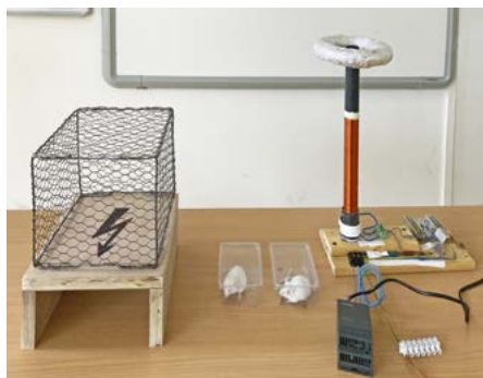
Faradayova klec a Teslův transformátor
