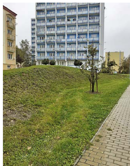
Okolní zpevněné i nezpevněné plochy jsou spádovány do průlehu v zeleni, ve kterých se shromáždí voda při přívalem deštích. Postupně se voda odpaří nebo vsákne.
